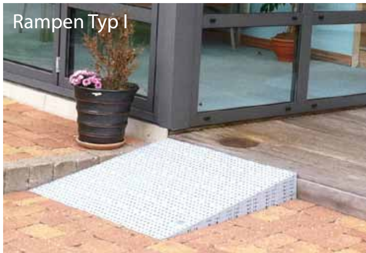
Rampen Typ I, Neigung 1:7 (14,5%) Grade Oberfläche für elektrischen Rollstuhl.
